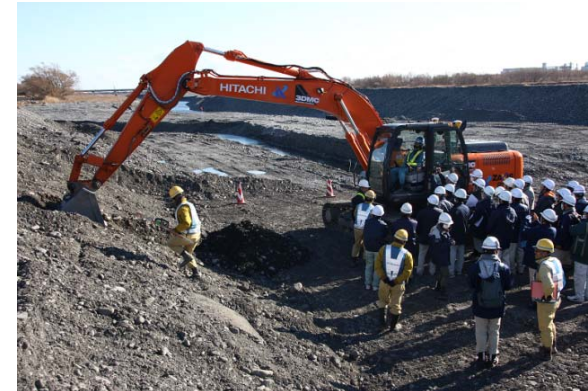
マシンコントロールバックホウの実演
