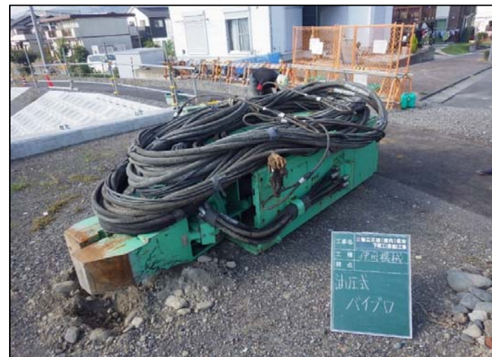
油圧バイブロ(242Kw起震力0~580KN)
