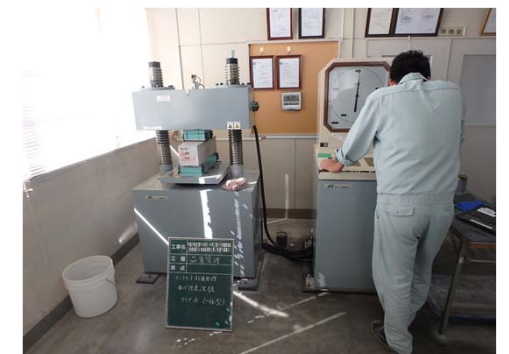
コンクリート曲げ試験状況
