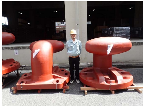
写真-4 係船柱写真(左：入荷前、右：設置完了後)
