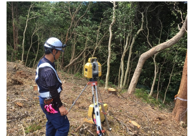
写真10 - 3Dレーザースキャナによる測量
