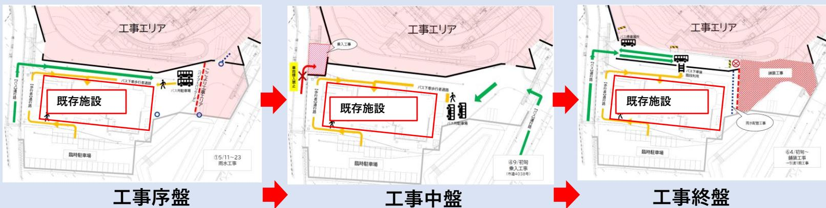
既存施設周辺の関係者の利用を妨げないように、既存施設と取り合う外構工事をフェーズ毎に分けて実施し、施設関係車両の動線の確保を行いました。既存火葬場に車両を横付けしなければならない施設運営に対して、有効な手段となりました。また、既存施設へのスムーズな動線確保の為、台車の移動や高齢者に配慮した屋根付き、段差無し、滑り止め仕様付きの仮設スロープを設置しました。
